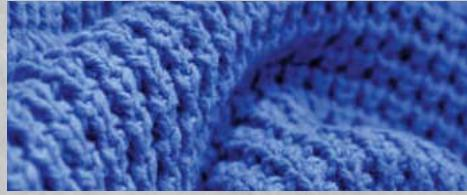
Strickstoffe zeichnen sich durch ihre gerippte Struktur aus, mit dichtem und dehnbarem Gewebe.
